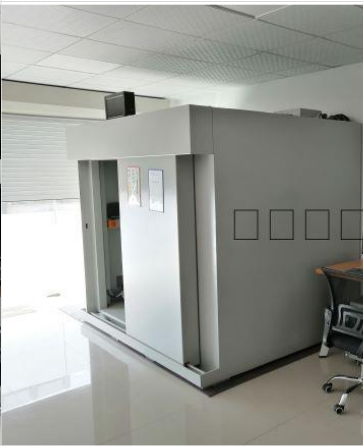
300kV 射线检测工作站
